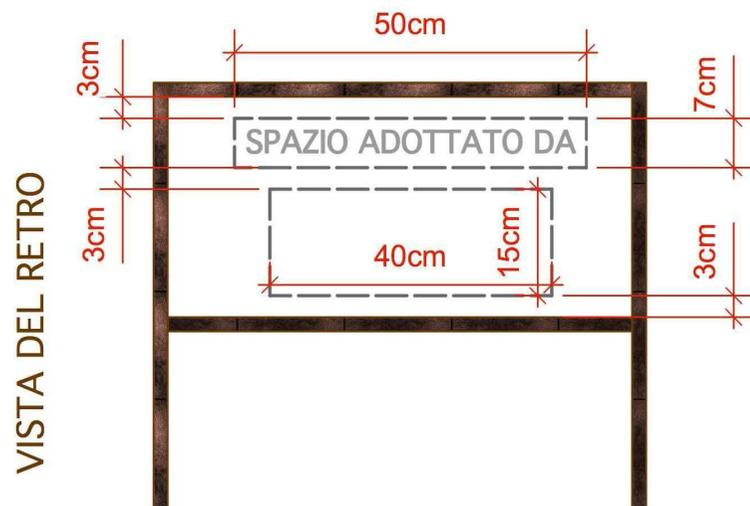
1- struttura in profilato scatolare di ferro di sezione 20 x 20 mm. finito con vernice micaceo chiaro infisso nel terreno senza fondazione in calcestruzzo
