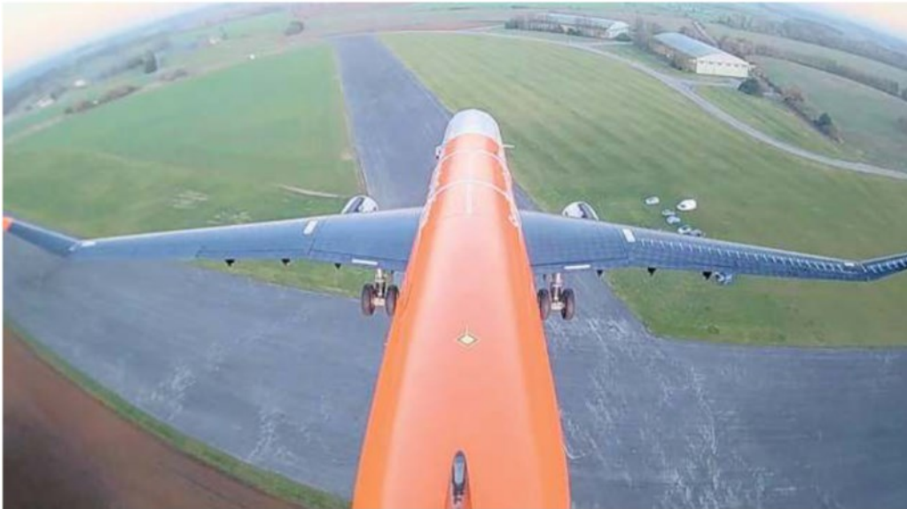
L'AlbatrossOne di Airbus può alzare le estremità delle ali per adattarsi al vento e alle turbolenze
