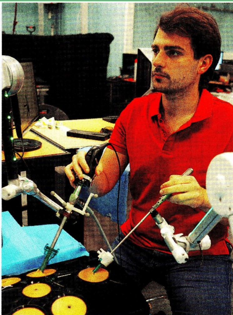
Mario Aricò , classe 1990, ingegnere biomedico, mentre manovra il dispositivo progettato per il dottorato di ricerca in Chirurgia robotica all'Istituto di sistemi intelligenti e robotica (ISIR) CNRS / Università della Sorbona
